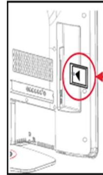
5. Jetzt kann das bestückte Modul in den CI+ Schacht des Fernsehers gesteckt werden. Auf dem Bildschirm sollte nun die Initialisierung angezeigt werden (mehrere Schritte).
